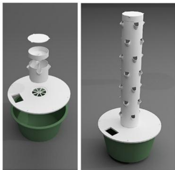
شکل ۱- طرح‌واره یکپارچه و تفکیکی ستونی سامانه
