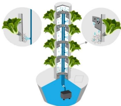
شکل ۵- سامانه ترکیبی هیدرو- آئروپونیک ستونی
