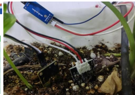
شکل ۳. سنسورهای سنجش رطوبت خاک (تصویر سمت راست) و نمونه‌ای از داده‌های دمایی و رطوبتی هوا و خاک ارسال شده به سرور کامپیوتر با قابلیت نمایش آنلاین وضعیت لحظه‌ای گلخانه ( https://www.bioiots.ir ) (تصویر سمت چپ)
